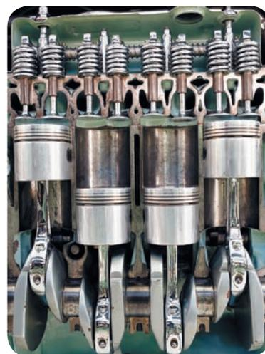
► O pistão de um motor é uma peça cilíndrica metálica deslizante que recebe um movimento de vaivém no interior de um cilindro de motor de combustão interna.
